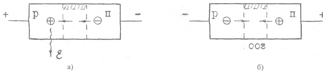
Рисунок 1 – Протекание тока в р-п переходе при прямом (а) и обратном (б) напряжении
